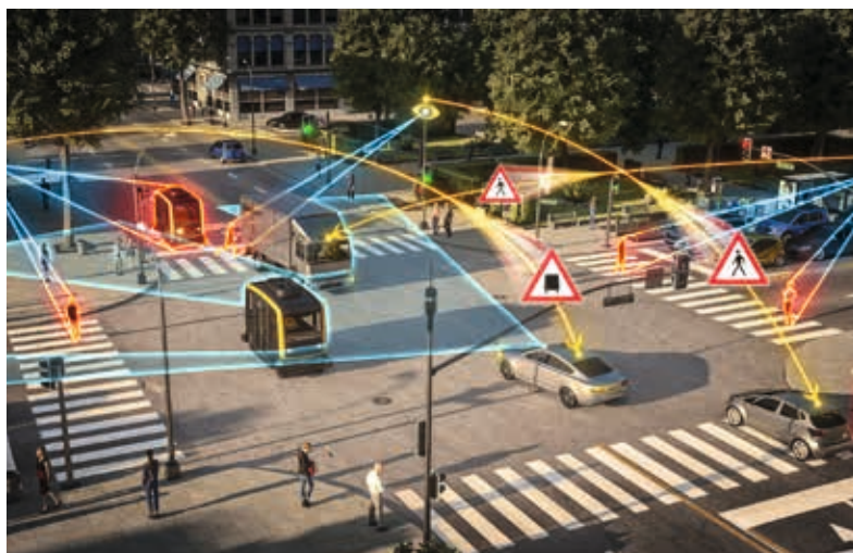
Inteligentno umrežavanje Infrastrukturni elementi poput semafora i ulične rasvjete također komuniciraju s vozilima kako bi upozorili vozače
